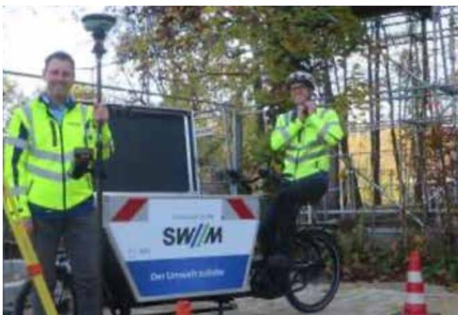
Die Ausrüstung mit Tachymeter, GPS, Stativ und Vermarkungsmaterial findet in der Lastenbox genauso Platz wie ein Ersatz-Akku für die E-Unterstützung, die man bei diesem Gesamtgewicht benötigt. Bestandsaufnahmen, Absteckungen oder das Einmessen von Leitungen sind mit dem Lastenrad kein Problem. Zugegeben, es kann das Auto nicht komplett ersetzen. Auf dem Rad ist man Wind und Wetter ausgesetzt und die Wege zwischen den Baustellen sind manchmal recht weit.
